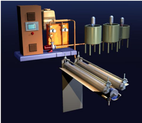
**Figure 2. KissRoll Applicator Schematic Illustration**
